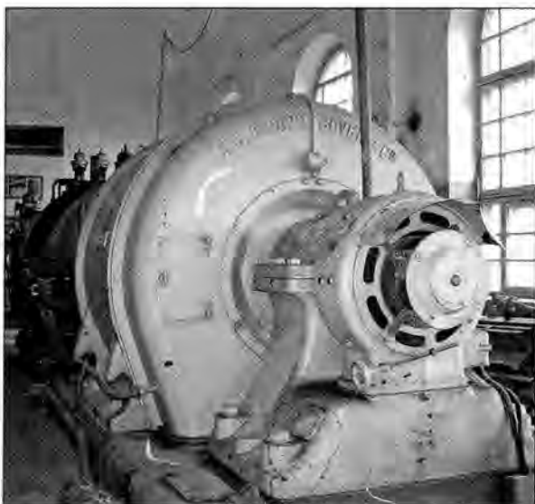
Турбогенератор Центральної електростанції. Фірма "Броун, Бовери і К°". Фото автора 2007 р.
