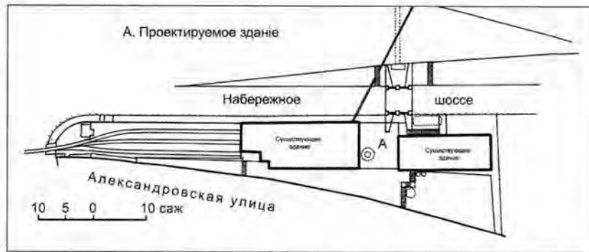
План першого Олександрівського трамвайного парку з двома електричними станціями – старою та новою. Архівний кресленик початку ХХ ст. (копія).
