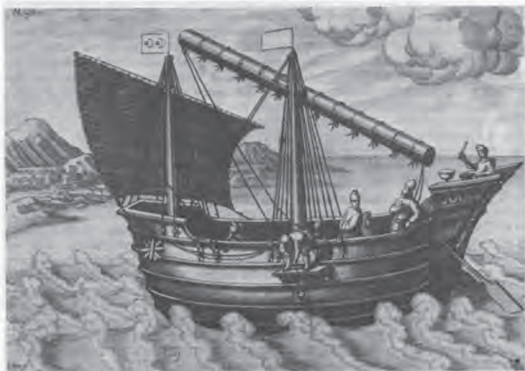
Яванская барка. Отметим деревянный якорь, паруса из бамбука и два рулевых весла на корме. Фототека издательства А. Колэн.
