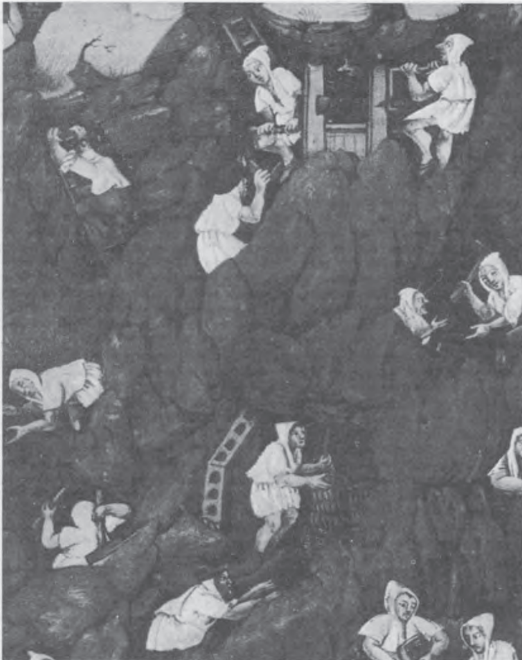
Деталь миниатюры конца XV в., изображающая серебряный рудник в Кутной Горе в разрезе по вертикали, как это принято. Забойщики в белых одеждах, лестницы, подъемный ворот. На той части миниатюры, которую мы не воспроизводим, показано весьма современное техническое оснащение (немцы были тогда мастерами в технике горного дела): ворота, приводимые в движение лошадьми, системы водоотлива и вентиляции. Вена, Австрийская национальная библиотека. Фото библиотеки.
