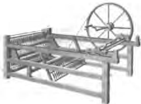
Слева Прядильная машина «Дженни» наматывала нити сразу на несколько веретен, что значительно повышало производительность
