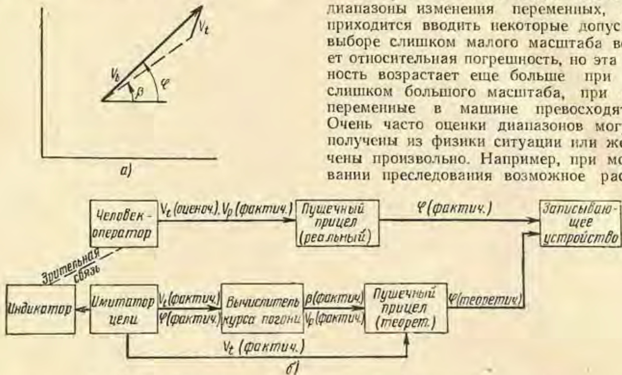
Рис. 18.12. Моделирование испытания авиационного пушечного прицела: а) геометрия, б) аппаратура.
