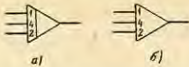
Рис. 17.8. Обозначение операционных усилителей с цепью обратной связи: а — инвертирующий; б — суммирующий.
