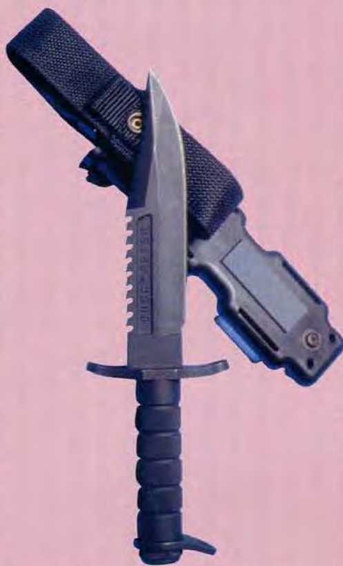
Нож для выживания фирмы Buck Knives. Особенность конструкции – мощная гарда, в которую вворачиваются сменные штыри, превращающие нож в «кошку»
