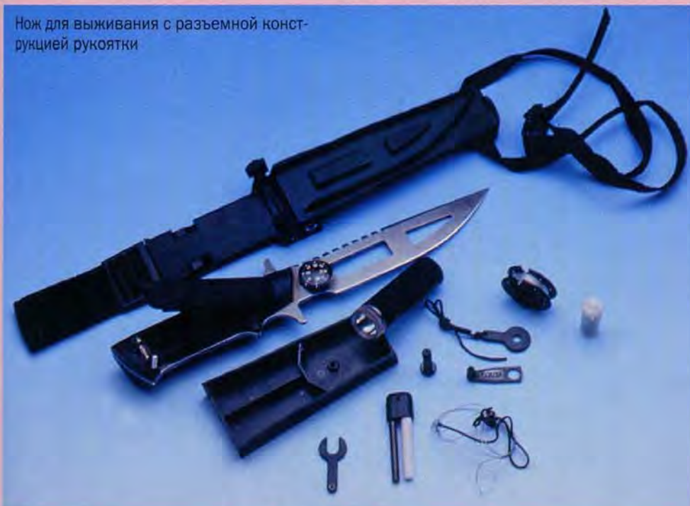
Нож для выживания фирмы Buck Knives. Особенность конструкции – мощная гарда, в которую вворачиваются сменные штыри, превращающие нож в «кошку»
