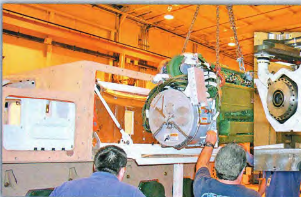
Монтаж гибридной силовой установки на NLOS-C
