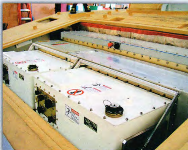
Расположение аккумуляторов в носовой части машины
