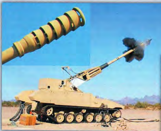
Стрельба с шестьюрядным дульным тормозом. Видно, как истекающие газы делятся на три потока — один вверх, два других — вниз под углом 120^\circ
