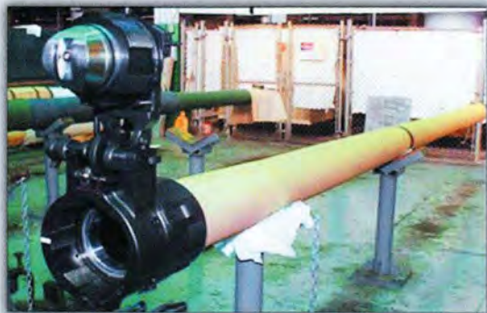
Казённая часть ствола XM324 имеет минимальные габариты
