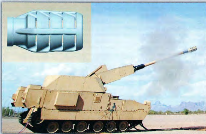
Стрельба с четырёхрядным бескамерным дульным тормозом. Полигон Юма, 23 сентября 2008 г.
