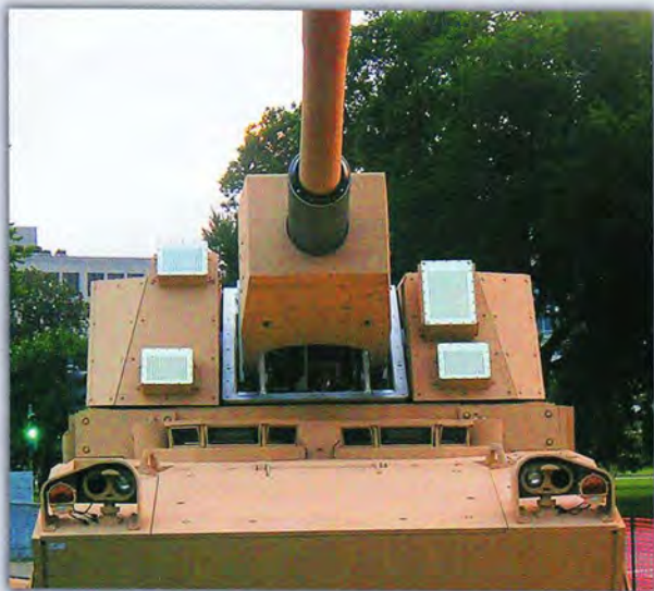
Элементы системы PTS для слежения за снарядом, установленные на башне NLOS-C P
