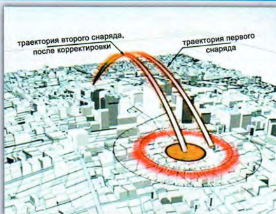
Корректировка траектории с помощью радара
