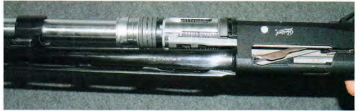
Газовый узел и сжатая возвратная пружина MP155. Вид справа
