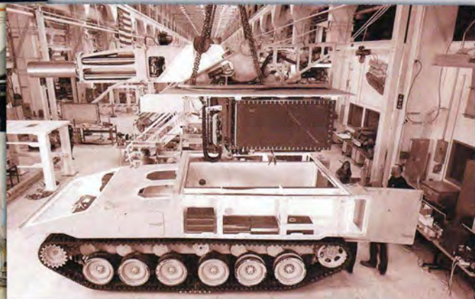
Монтаж на «огневую платформу» NLOS-C башни с автоматом заряжания и отсеками для боеприпасов. Чёрный прямоугольник в центре правого снимка — отсек для модульных зарядов
