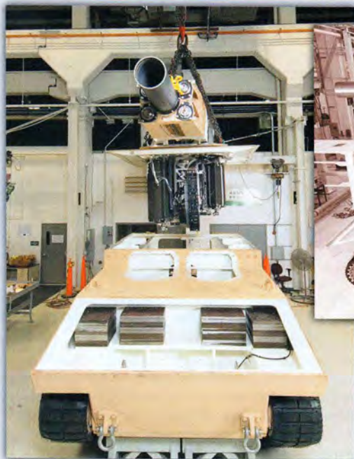
Монтаж на «огневую платформу» NLOS-C башни с автоматом заряжания и отсеками для боеприпасов. Чёрный прямоугольник в центре правого снимка — отсек для модульных зарядов
