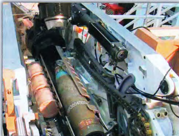
Автомат заряжания: снаряд на линии досылания, слева в лотке три модульных заряда
