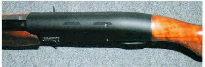
Пазы – посадочные места кронштейнов прицелов и планок на MP155
