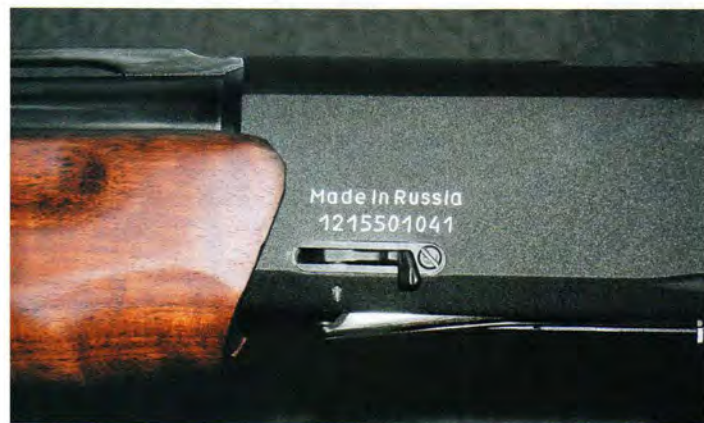
Отсекатель патронов магазина на MP155 находится с левой стороны ствольной коробки
