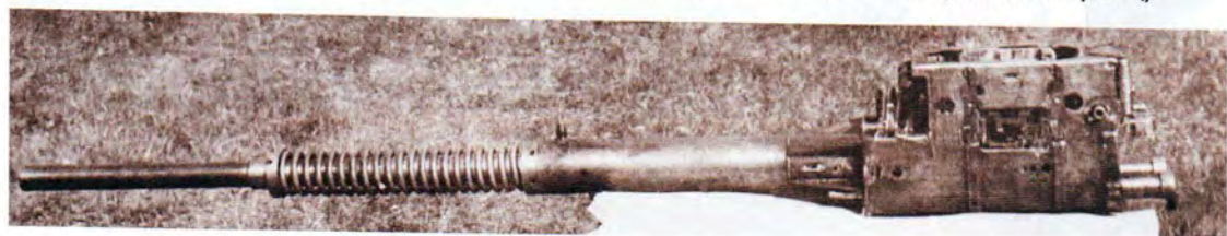
Авиационные пушки семейства В-14: 37-мм авиационная пушка В14-113(опытный образец)
