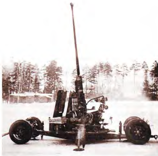
Опытное орудие С-60-А. Сразу замечается отличие от войсковых образцов в конструкции дульного тормоза
