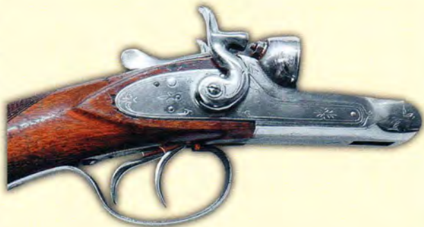
Ствольная коробка ружья МБ-12 со снятым блоком стволов
