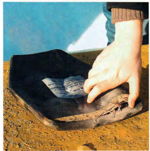
С внутренней стороны защитного элемента отверстий от пуль нет, значит, бронезилет выдержал попадание пули от СВД
