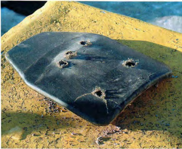
Следы от попаданий пуль из СВД с наружной стороны защитного элемента бронезилета
