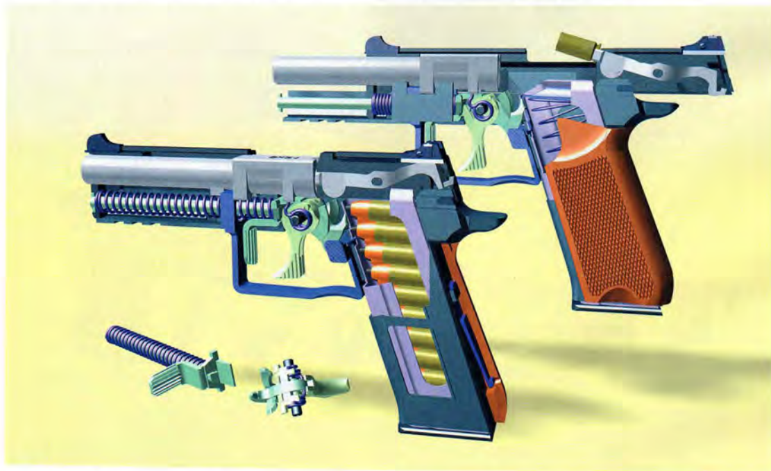
На переднем плане — разрез пистолета с досланным патроном и включённым предохранителем, затвор и спуск заблокированы. На заднем — затвор на затворной задержке, функцию которой выполняет поднятый подавателем курок. Внизу — возвратный и ударно-спусковой механизмы
