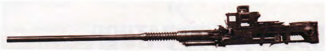
Авиационные пушки семейства В-14: 57-мм авиационная пушка В14-112 (опытный образец)
