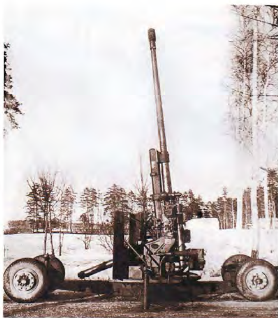
«Конкурентка» КС-19 — 100-мм зенитная пушка С-25 (опытный образец)
