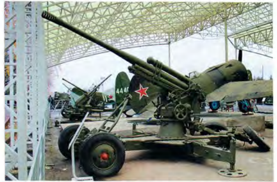
Легендарная 85-мм образца 1939 г. (52-К), которая успешно поражала даже танки
