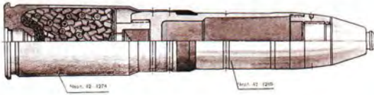
37-мм осколочно-фугасный зажигательный трассирующий снаряд, разработанный в НИИ-58 для пушки В14-113, при попадании гарантированно выводил из строя бомбардировщик Пе-2
