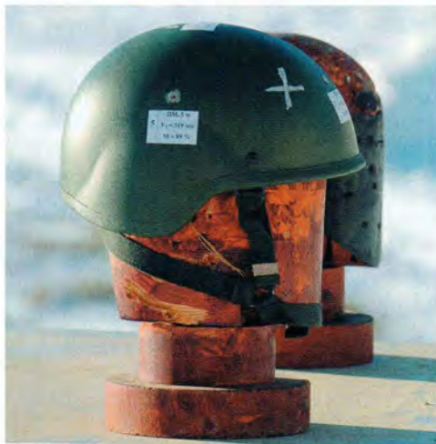
След на каске от пулевой пули, выпущенной из ПМ с расстояния в 10 м
