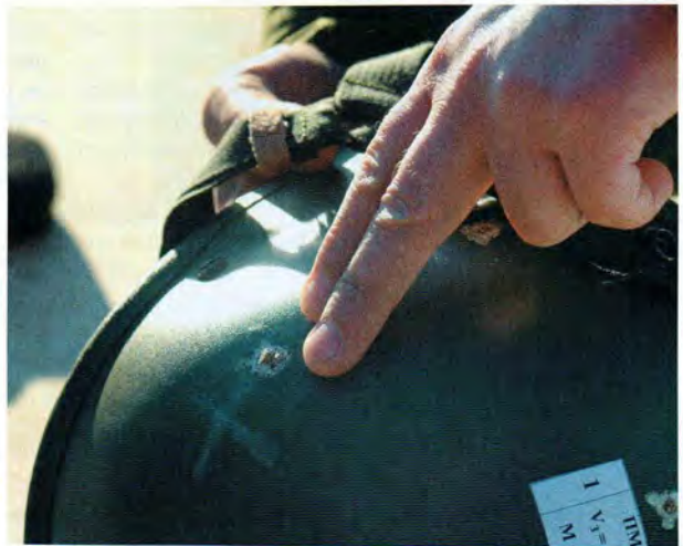
При ближайшем рассмотрении видно, что шлем попадания пулевой пули выдержал — в месте попадания даже не все волокна верхнего слоя разошлись
