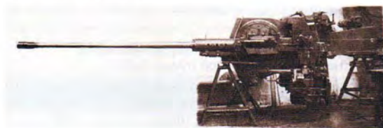
57-мм спаренная зенитная пушка 0903 (опытный образец)
