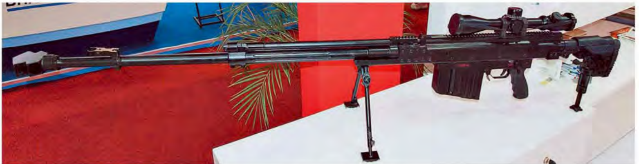
Другая разработка азербайджанских оружейников — 12,7-мм снайперская винтовка IST-12,7 имеет газоотводную схему автоматики, вместимость магазина семь патронов и массу с прицелом 16 кг
