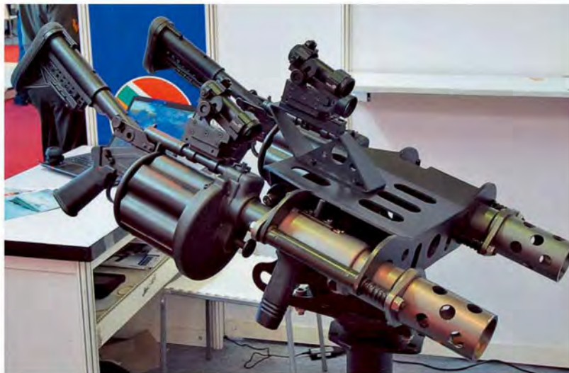
Спарка 40-мм ручных гранатомётов компании Rippef Effect (ЮАР) позволяет вести огонь 40x46 мм выстрелами с максимальной дальностью стрельбы до 400 м и 40x51 мм выстрелами на дальность до 800 м
