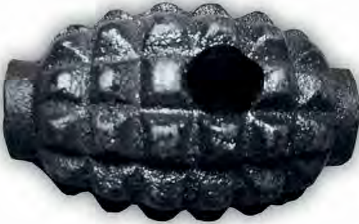
Учебная мина PUM-93b (отчётливо видно отверстие для выхода пороховых газов)
