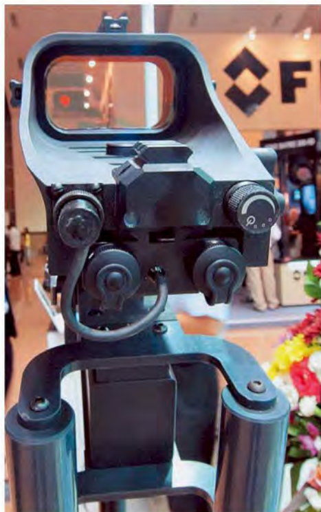
Коллиматорный прицел фирмы D.I. Optical (Ю. Корея), предназначенный для 12,7-мм крупнокалиберных пулемётов, отличается большой размер экрана (120x70) (слева)
