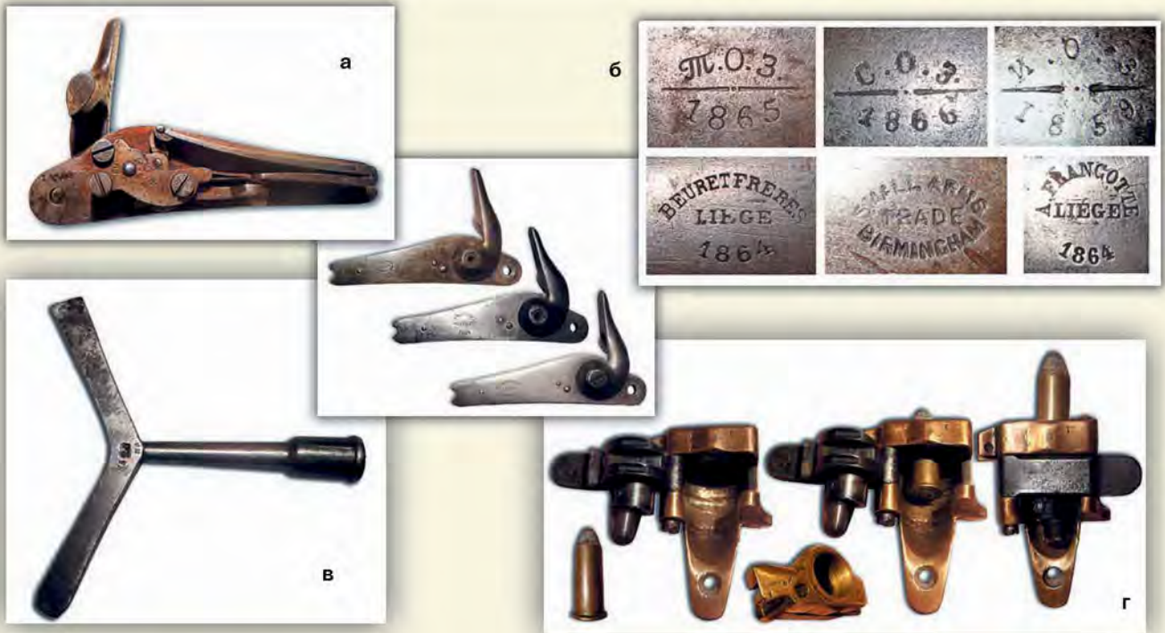
а. Замок к винтовке системы Крнка.
