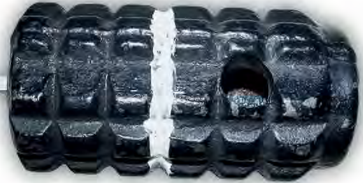
Учебная мина PUM-93a (отчётливо видно отверстие для выхода пороховых газов)
