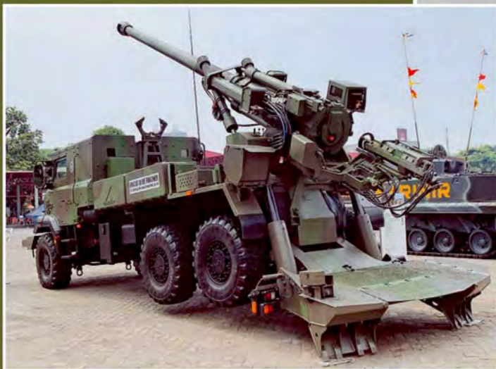
Французская 155-мм самоходная артиллерийская установка Caesar позволяет вести огонь на дальность до 42 км, производя до шести выстрелов в минуту
