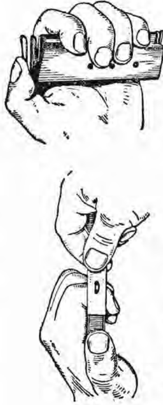
Рис. 84. Как снять крышку магазина
