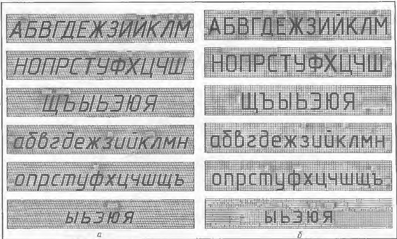
Черт. 2.10.4. Русский алфавит. Шрифт типа Б: а — с наклоном; б — без наклона.
