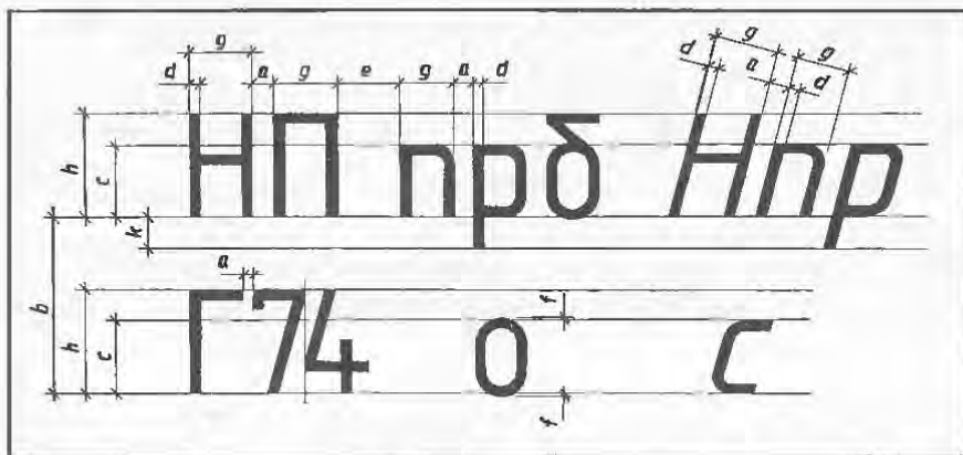
Черт. 2.10.1. Параметры чертежного шрифта (обозначения см. табл. 2.10.1).
